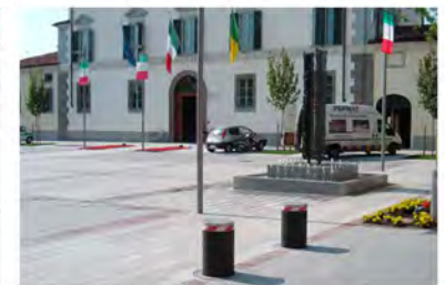
_dissuasori a scomparsa automatizzati
